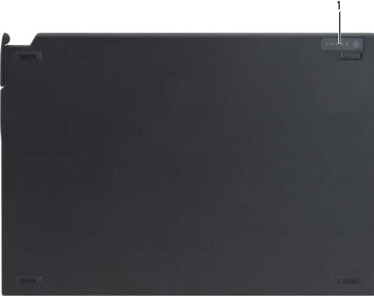
1 LED de estado de la batería laminar
