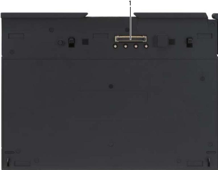
1 Conector de acoplamiento
